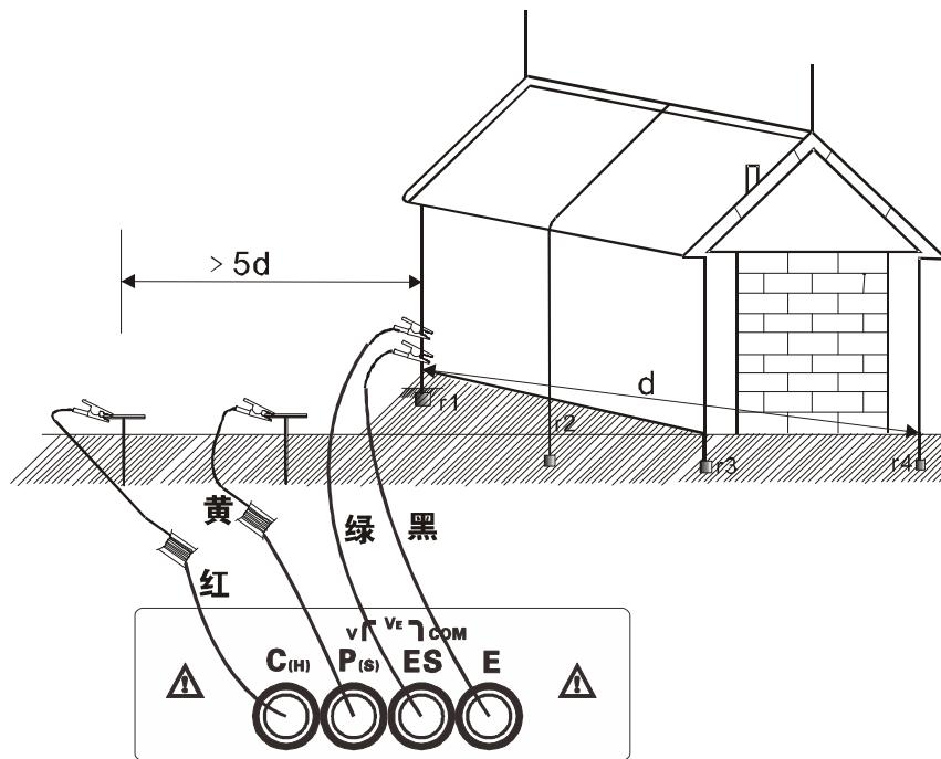
$$R = r_1 // r_2 // r_3 // r_4 // r_5 // \dots // r_n \quad (r_1 \dots r_n \text{ 都是独立接地点})$$
