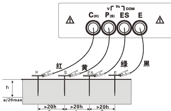
辅助接地棒的间距设置：连接好测试线后，开机按功能按键  $\rho$ ，进入土壤电阻率测试模式，长按“SET”键(超过 3 秒)进入辅助接地棒的间距设置，短按“ $\bullet$ ”键移动光标，按“ $\Delta$ ”或“ $\nabla$ ”键改变当前数字大小(a 值范围: 1m~100m)，再长按“SET”键(超过 3 秒)保存设定的 a 值，并返回土壤电阻率测试模式。
